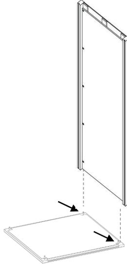
Engager les panneaux dans les goujons métalliques **B** et verrouiller avec les **K**
