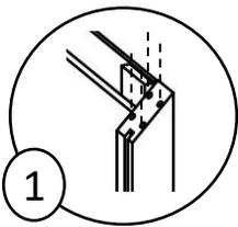
1 Positionner les tourillons dans les perçages des montants.
