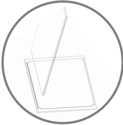
Engager le fond de la cabine (vitrage ou fond plein) dans la rainure du **montant** et du **socle**.
